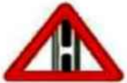
मध्य पट्टी में अंतर Gap in Median
